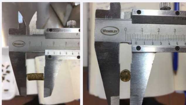
Medición de Largo y Diámetro de pellets
